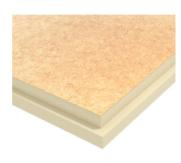
**PirroInterior** — теплоизоляционная плита из жесткого пенополиизоцианурата (PIR) с двухсторонней облицовкой из крафт-бумаги. Пенополиизоцианурат представляет собой полимерный материал группы реактопластов с закрытоячеистой структурой. Структура PIR представляет собой систему замкнутых сшитых ячеек, в силу чего материал приобретает высокую механическую прочность.
