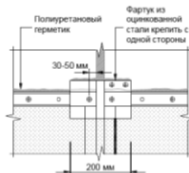
Рис. 5.25 Краевая рейка на стене из бетонных плит
