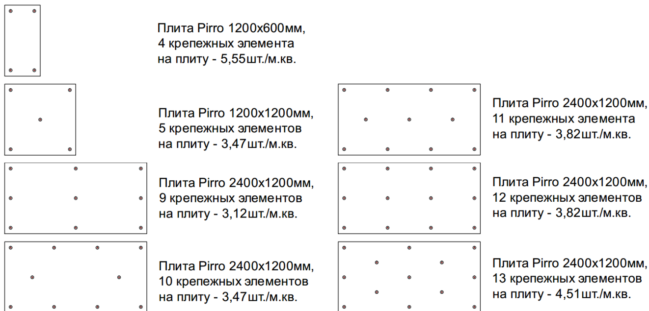
Рис. 5.5. Рекомендуемое расположение крепежных элементов по плите
